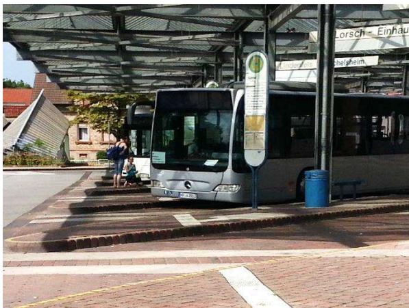
**Abbildung 8a:** Für Blinde ist der aktuelle Zugang zu den Bussteigen unakzeptabel (Stolperfalle, an Kante diagonal endender Leitstreifen, Busse im Weg).
